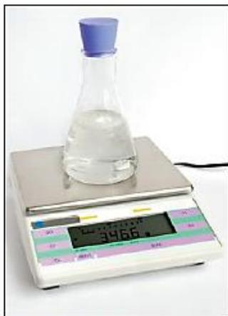
▲ Se agregó la pastilla y se cerró el matraz rápidamente. La balanza registra la masa del sistema.
